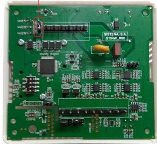
Resistencia de final de línea
